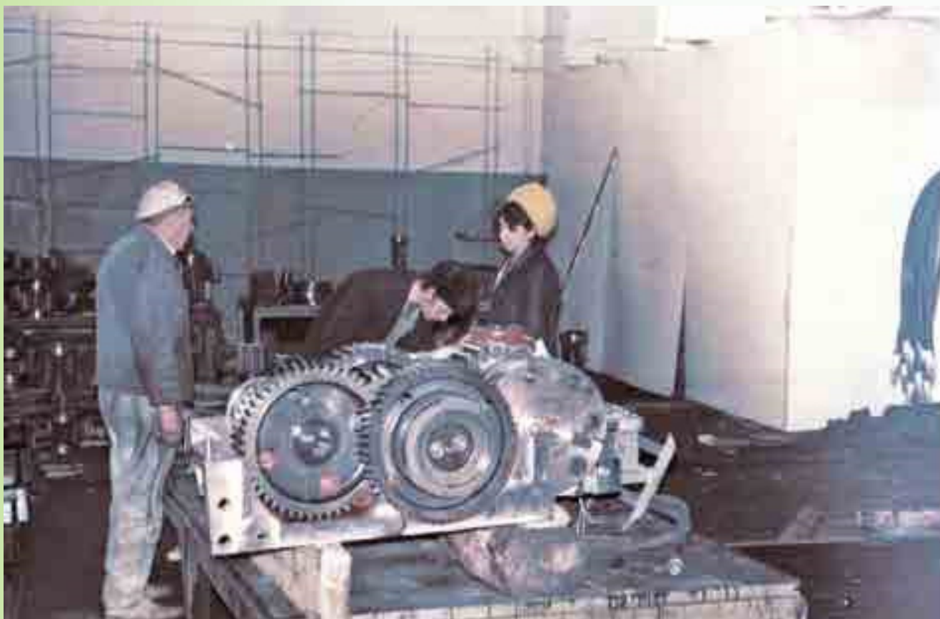
Экспериментальный завод ШахтНИУИ. Сборка редуктора струговой установки.
